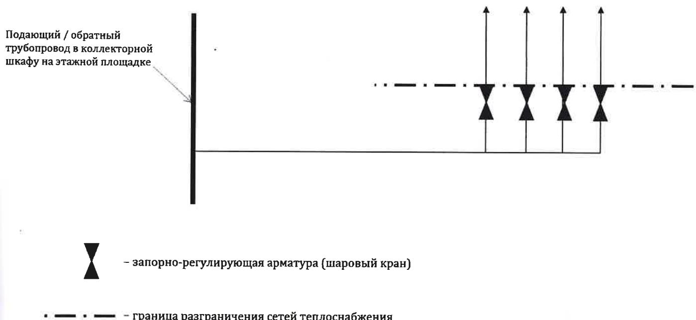
**Граница разграничения сетей теплоснабжения (вертикальная (стоечная) двухтрубная разводка)**
