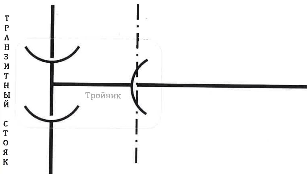
**Граница разграничения сетей теплоснабжения (коллекторная (горизонтальная) разводка)**
